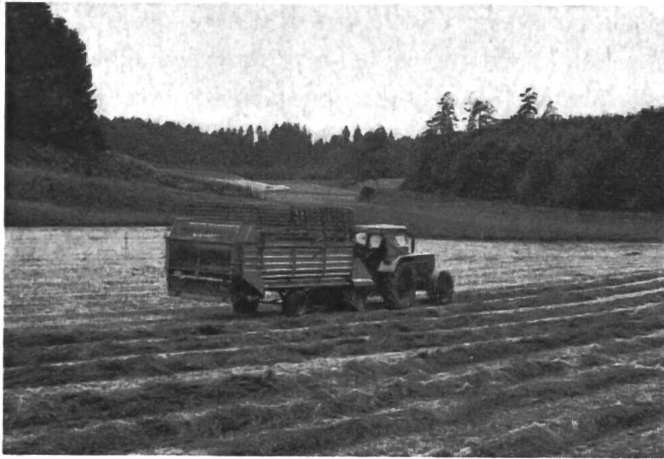
Fig. 3: Ainsi que son nom l'indique, la remorque autochargeuse polyvalente Claas LWU est plus qu'une autochargeuse de type courant. En pourvoyant son dispositif de coupe de 23 couteaux, il est possible de l'employer également pour le ramassage-rentage des fourrages à ensiler. Le déchargement des produits, tant sur le côté gauche que sur le côté droit ainsi qu'à l'arrière, peut se faire avec des tambours doseurs (fraiseurs) et un convoyeur transversal à ruban.
