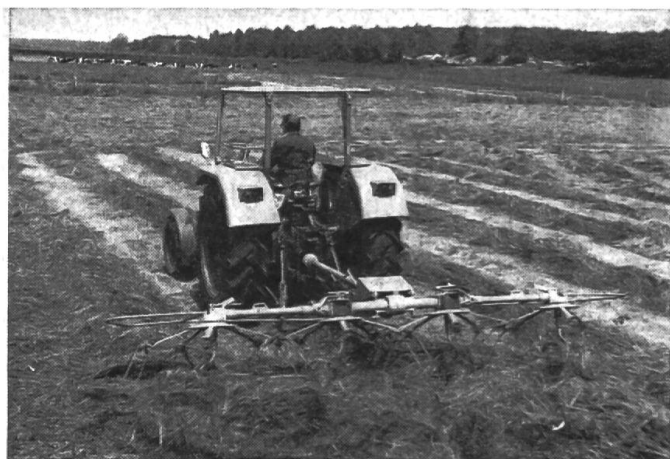
Fig. 1: L'épandeur-faneuse Claas W 450 à toupies est une machine spécialement prévue pour l'éparpillement et le retournement des fourrages verts, préfanés, mi-secs et secs. Les andains de fauchage sont régulièrement répartis, et de façon aérée, sur le champ. Malgré sa grande largeur de travail (4 m 50), cette machine s'adapte très bien aux inégalités du sol par le fait que chacune des quatre grandes toupies est guidée par sa propre roue têteuse.
