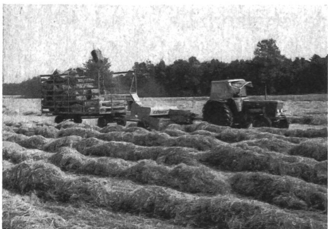
Fig. 2: Pour le ramassage de la paille laissée sur le champ par la moissonneuse-batteuse, et également pour celui du foin (pratique de plus en plus utilisée), la ramasseuse-presse à haute densité représente la solution qui permet d'économiser de la main-d'œuvre. Si on lui accouple un lanceur de balles (on voit ici le modèle Markant 50 de la Fabrique Claas), les balles sont automatiquement chargées. A relever que cette méthode se répand de plus en plus.
