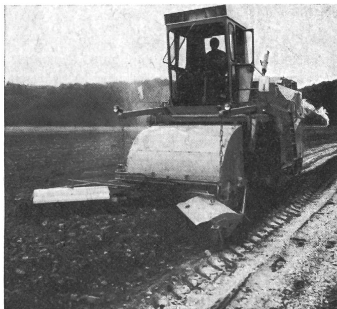
Concasseur de pierres agricole avec moteur Diesel Perkins réalisé par la Fabrique Ratzinger, à Munich.
