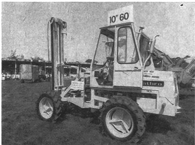
sa sécurité d'emploi. Le moteur, l'installation hydraulique et le réservoir à carburant sont logés à l'arrière, ce qui rend d'encombrants contrepoids superflus. Un cadre de levage latéral, pouvant être mis en position oblique, assure l'élévation correcte de la charge.
