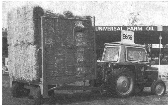
reprise au sol du tas de balles empilées ou de la balle de très grandes dimensions, on fait pivoter la cage et provoque l'abaissement de sa partie supérieure. Puis les parties latérales de la cage sont verrouillées et on fait pivoter cette dernière en sens contraire, selon un angle de 90°, pour qu'elle repose à nouveau sur le plateau tournant du timon. Les balles sont solidement fixées et peuvent être alors transportées rapidement et sans risques au lieu de destination.
