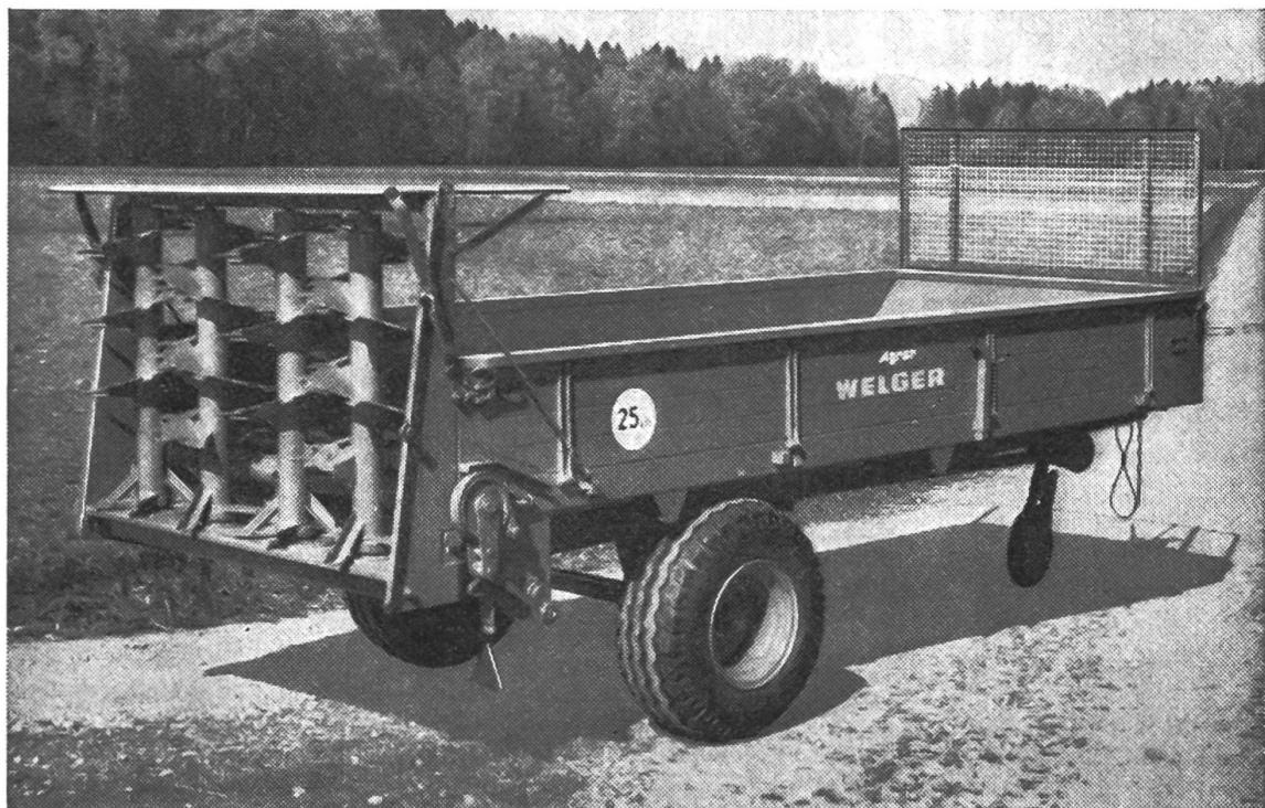
La construction robuste, le maniement simple, la distribution large et régulière, le réglage aisément de la quantité de fumier à épandre depuis le siège du tracteur, livrable en 5 différentes grandeurs, avec 2 ou 4 rouleaux distributeurs.
