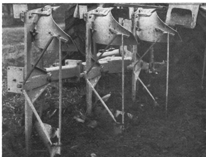
Fig. 4: Charrue réversible trisoc construite par l'assemblage d'unités de montage, ce qui offre la possibilité d'en faire sans peine une charrue réversible bisoc en enlevant une paire de corps.
