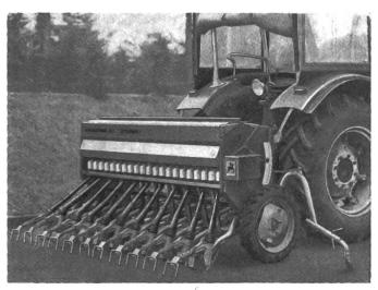
Fig. 7: Le semoir en lignes Amazone 07 «Spécial». Ses caractéristiques: semis de précision / dépôt des graines à une profondeur uniforme / coupleur rapide / dispositifs automatiques pour la mise en œuvre des traceurs et pour circuler sur les voies de roulage.
