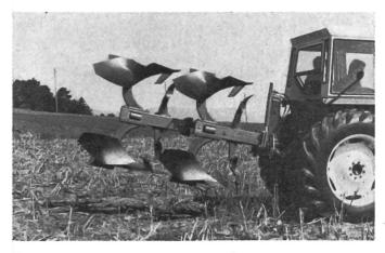
Fig. 3: La charrue Jura Non Stop est notamment équipée d'un coupleur rapide, d'un dispositif de retournement hydraulique et d'un système hydraulique de sécurité contre les ruptures. Ce système intervient comme suit:
