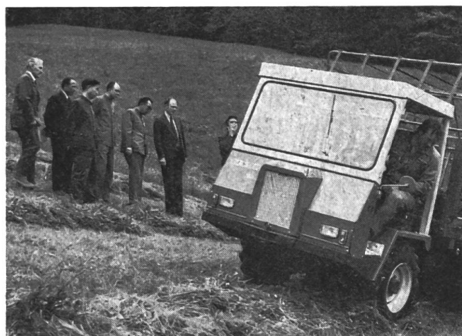
Fig. 2: Les Délégués chinois suivent attentivement les évolutions d'un char automoteur au cours d'une démonstration. Ce véhicule de transport et de travail polyvalent utilisable sur tous les terrains comporte quatre roues motrices.
