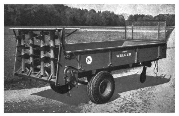
La construction robuste, le maniement simple, la distribution large et régulière, le réglage aisé de la quantité de fumier à épandre depuis le siège du tracteur, livrable en 5 différentes grandeurs, avec 2 ou 4 rouleaux distributeurs.
