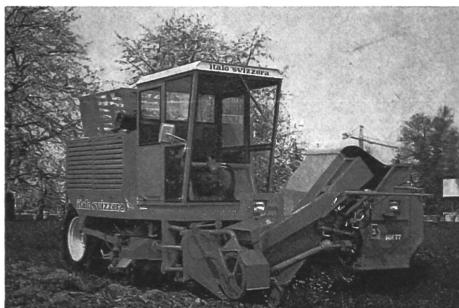
Fig. 9: Décolleteuse-arracheuse-débardeuse automotrice à un rang, 4 roues motrices et un dispositif d'andainage transversal. Tous les agrégats sont actionnés par moteurs hydrauliques.
