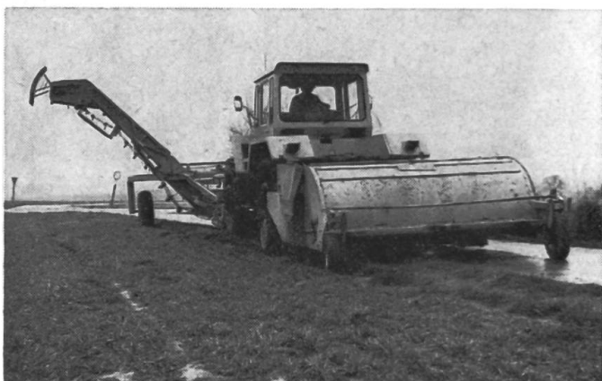
Fig. 17: Système de récolte séparé à trois rangs (Schmotzer) à 4 variantes de rentrée des verts.
