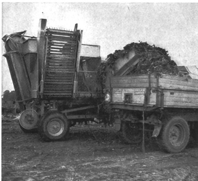
Fig. 8: Décolleteuse-arracheuse-débardeuse avec effeuilleuse-hacheuse et trémie. La structure du sol est moins entamée, la qualité de fourrage des verts est excellente, pas de retard pour les autres travaux de cultures, tels sont les avantages de ce procédé. Ces machines exigent toutefois de lourds tracteurs, à partir d'environ 60 kW (80 CV).
