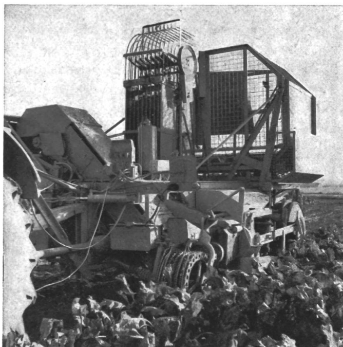
Fig. 1: Décolleteuse-arracheuse-débardeuse à un rang à commande électro-hydraulique. On ne peut pas s'attendre à une augmentation de capacité efficace de ce genre de machine à un rang.
