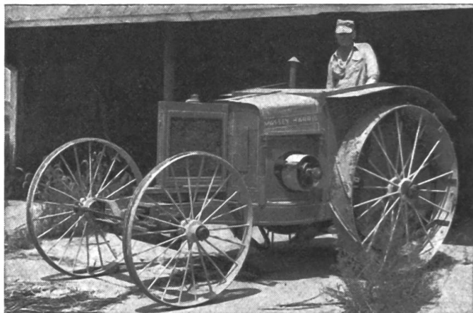
Fig. 4: Premier tracteur Massey-Ferguson fabriqué il y a 60 ans en tant que modèle Massey-Harris no 1. Il était pourvu d'un moteur à essence à 4 cylindres fournissant une puissance de 12 ch à la prise de force et de 25 ch à la poulie.
