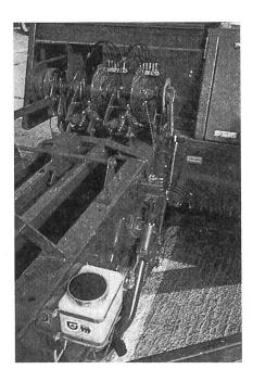
15. Nettoyer les chaînes et les plonger dans de la graisse à chaînes très chaude jusqu'à ce qu'aucune bulle d'air ne monte plus à la surface. La graisse à chaînes la plus appropriée est un mélange de 1 kg de graisse industrielle (graisse de boeuf) et de 100 à 200 g de poudre de graphite. Remettre ensuite les chaînes en place sans les tendre.
