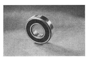
liers à graissage permanent ne doivent pas être garnis de graisse fraîche. Leur durée utile dépend par conséquent des sollicitations auxquelles ils se trouvent soumis et de la réserve de graisse. Il convient de contrôler autant que possible le jeu de tous les paliers. Ceux qui ont besoin d'être remplacés doivent être notés sur la liste des défectuosités.
