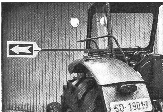
Fig. 1: Indicateur de direction rationnel: modèle extensible et pivotant muni d'une palette très visible (fluorescente de jour, réfléchissante de nuit).
