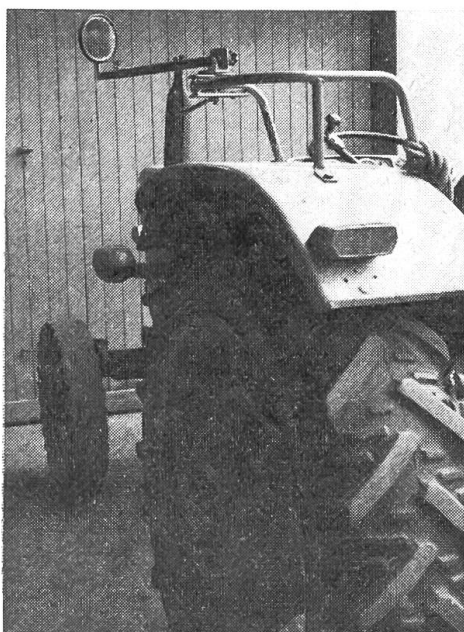
Fig. 2: Rétroviseur (indispensable quand la visibilité est mauvaise ou nulle vers l'arrière) fixé au dossier d'un siège de passager.
