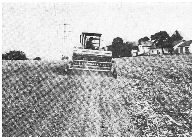
Fig. 4: Semis direct, c'est-à-dire sans labour préalable, effectué avec la combinaison de machines formée d'une fraiseuse à lames coudées et d'un semoir en lignes. Il s'agit d'un semis de féveroles faisant suite à une culture d'orge d'hiver.
