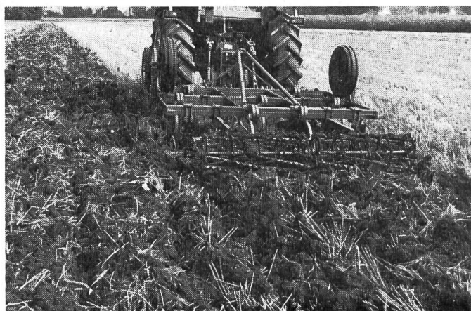
Fig. 6: Il ne convient pas d'accoupler une émotteuse à un chisel car le travail d'émiettement qu'elle fournit est insuffisant vu les dimensions des mottes que laisse ce dernier après son passage. Il est d'ailleurs possible de se passer d'une émotteuse dans la plupart des cas.
