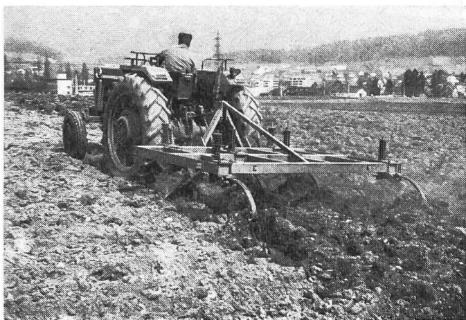
Fig. 1 et 2: Les buts d'utilisation des chisels (cultivateurs sous-soleurs) qui comportent des dents élastiques, sont déterminés par la forme et les dimensions de ces dernières. Les dents souples de grandes dimensions dont la section est carrée ou qui sont larges et plates permettent de bien ameublir le sol jusqu'à une profondeur de 25 à 30 cm et aussi d'effectuer de bons déchaumages.
