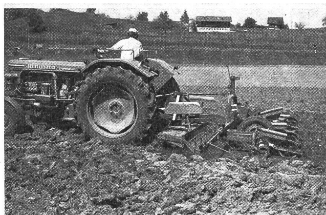
Fig. 10 et 11: Le hersage-semage est effectué sur un sol préalablement labouré par la charrue. La préparation du lit de germination et le semis se font ensuite simultanément, soit en un seul passage. Les matériels qui s'avèrent les plus appropriés avec cette méthode sont les herse à entraînement par prise de force (notamment les herse à toupies) et les semoirs en lignes de type traditionnel.
