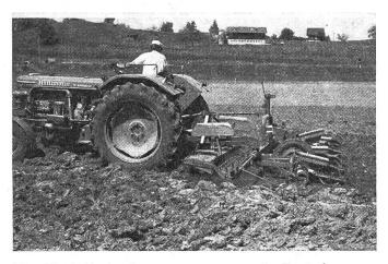
Fig. 10 et 11: Le hersage-semage est effectué sur un sol préalablement labouré par la charrue. La préparation du lit de germination et le semis se font ensuite simultanément, soit en un seul passage. Les matériels qui s'avèrent les plus appropriés avec cette méthode sont les herses à entraînement par prise de force (notamment les herses à toupies) et les semoirs en lignes de type traditionnel.
