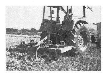
Fig. 1 et 2: Les buts d'utilisation des chisels (cultivateurs sous-soleurs) qui comportent des dents élastiques, sont déterminés par la forme et les dimensions de ces dernières. Les dents souples de grandes dimensions dont la section est carrée ou qui sont larges et plates permettent de bien ameublir le sol juqu'à une profondeur de 25 à 30 cm et aussi d'effecteur de bons déchaumages.
