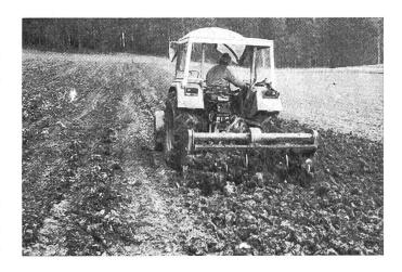
l'immobilisation des bêches. La qualité du travail réalisé par les machines en question est fortement influencée par la vitesse d'avancement. Par ailleurs, le mouvement relativement lent des bêches exige que cette vitesse ne dépasse pas en principe la limite de 2,5 km/h, sinon la largeur de la tranche de terre découpée est trop grande et l'ameublissement de la terre n'a lieu que de façon incomplète.
