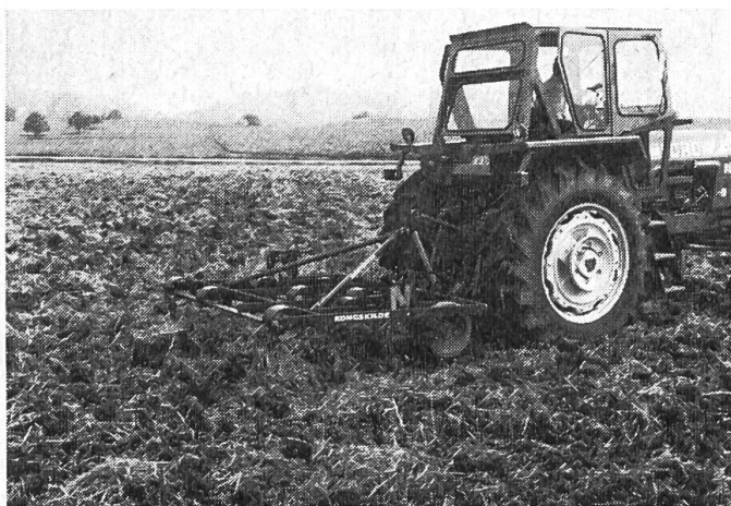
Fig. 4 et 5: Pour les déchaumages, où le sol doit être travaillé jusqu'à une profondeur de 15 à 20 cm, n'importe quel type de chisel entre en considération, soit également ceux qui sont munis de dents semi-rigides.
