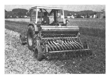
Fig. 9: Le fraisage-semage est exécuté en un seul passage, sur un sol non labouré, par une fraiseuse à lames sur laquelle a été monté un semoir en lignes. Cette méthode convient bien pour les cultures dérobées et le froment succédant à des plantes sarclées ou du maïs. Dans les terres lourdes, il est indiqué d'ameublir auparavant le sol jusqu'à une profondeur d'environ 20 cm en vue d'éviter la formation d'une surface lisse et grasse (semelle).
