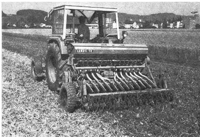
Fig. 9: Le fraisage-semage est exécuté en un seul passage, sur un sol non labouré, par une fraiseuse à lames sur laquelle a été monté un semoir en lignes. Cette méthode convient bien pour les cultures dérobées et le froment succédant à des plantes sarclées ou du maïs. Dans les terres lourdes, il est indiqué d'ameublir auparavant le sol jusqu'à une profondeur d'environ 20 cm en vue d'éviter la formation d'une surface lisse et grasse (semelle).
