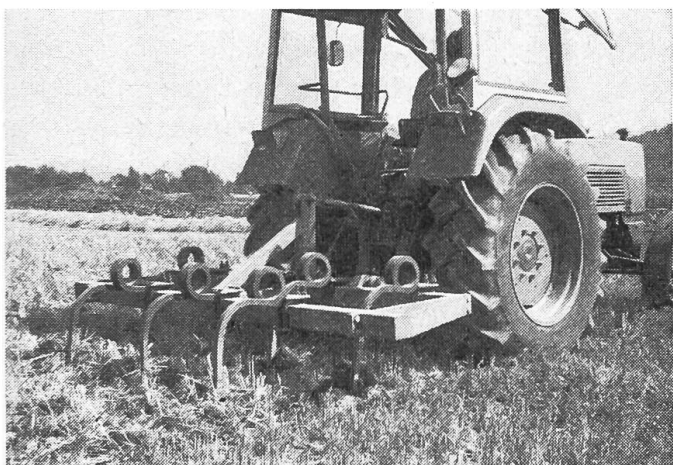
Fig. 1 et 2: Les buts d'utilisation des chisels (cultivateurs sous-soleurs) qui comportent des dents élastiques, sont déterminés par la forme et les dimensions de ces dernières. Les dents souples de grandes dimensions dont la section est carrée ou qui sont larges et plates permettent de bien ameublir le sol jusqu'à une profondeur de 25 à 30 cm et aussi d'effectuer de bons déchaumages.
