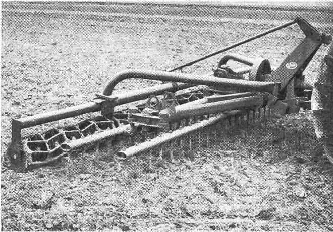
Fig. 1: Herse à barres oscillantes, commandée par la prise de force, à laquelle a été accouplé un rouleau émotteur à battes (rouleau-cage).
