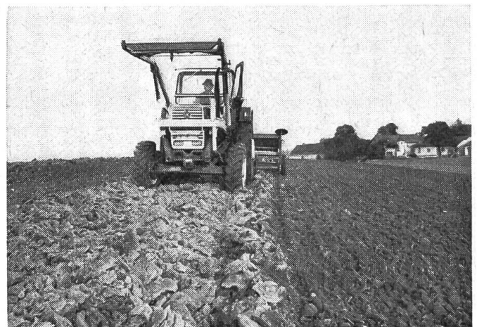
Fig. 3: Aspect d'un champ préalablement labouré sur lequel une herse à toupies combinée avec un semoir en lignes ont été ensuite mis en œuvre.
