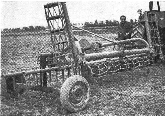
Fig. 2: Un chariot spécial a été prévu pour le transport en long de ce matériel de préparation du sol à très grande largeur de travail.
