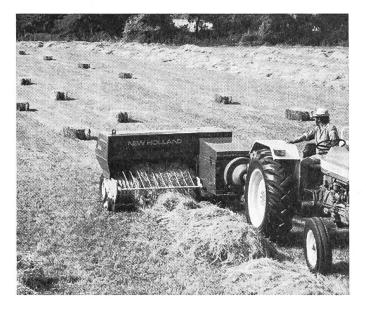
minute) et à l'entrée agrandie du canal de compression, on est arrivé à augmenter considérablement la capacité de travail de la ramasseuse-presse en question dans toutes les conditions de mise en service.
