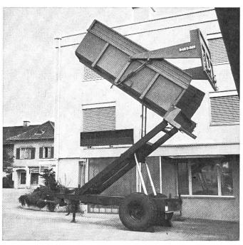
de façon continue de 1 m 35 jusqu'à une hauteur de 3 m 20. Cela permet entre autres de remplir facilement la trémie d'un distributeur d'engrais pour grandes surfaces et de déverser les betteraves sucrières sur de gros véhicules de transport ou bien dans des wagons de chemin de fer. La quantité de produit déchargée peut être réglée en relevant plus ou moins le hayon arrière à l'aide d'un vérin hydraulique.
