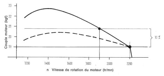
Si le besoin de puissance augmente de 10%, le régime du moteur du tracteur no. 1 baisse jusqu'à 1900 tr/mn. Le moteur du tracteur no. 2 n'arrive plus à fournir l'effort de rotation nécessaire et il va caler si l'on ne passe pas une vitesse inférieure.
