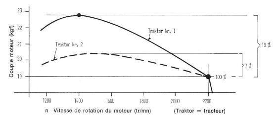
Les deux tracteurs ont la même puissance maximale, et, de ce fait, le même couple moteur au régime nominal (2200 tr/mn). Le tracteur no. 1 a un couple moteur qui augmente de 19%, tandis que celui du tracteur no. 2 ne s'accroît que de 7%.
