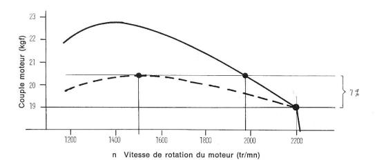
Si le besoin de puissance augmente de 7% à pleine charge (du fait d'une plus forte inclinaison de la rampe à gravir, par exemple), il se produit une baisse de régime du moteur (donc une diminution de la vitesse d'avancement) qui va jusqu'à 2000 tr/mn avec le tracteur no. 1 et jusqu'à 1500 tr/mn avec le tracteur no. 2.
