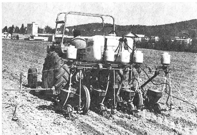
Fig. 1: Semis de maïs effectué au moyen de semoirs monograines en même temps qu'une pulvérisation d'herbicide sur bandes et un épandage d'insecticide sous forme de granulés.
