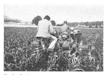
Fig. 3b: Etoiles sarcleuses avec ressorts à pression réglable et guidage par articulations.
