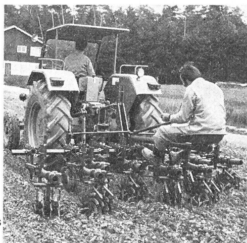
Fig. 3: Les sarcleuses à groupes d'étoiles ont fait leurs preuves pour l'élimination des mauvaises herbes que sont les variétés de millet. Un chaussage simultané des plantes de maïs s'avère également possible en donnant une position oblique aux groupes d'étoiles sarcleuses.
