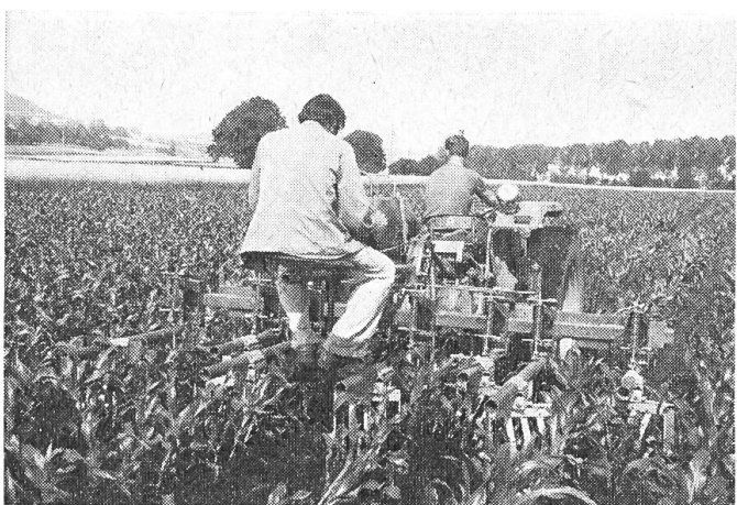
Fig. 3b: Etoiles sarcleuses avec ressorts à pression réglable et guidage par articulations.
