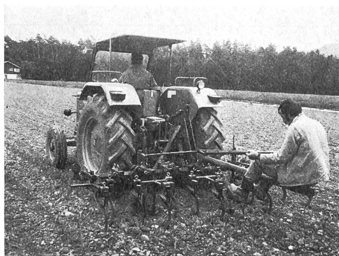
Fig. 2a: Instrument universel de type traditionnel équipé de socs à ailes fermées.
