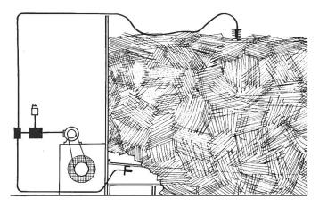
Commande automatique pour le séchage en grange.
