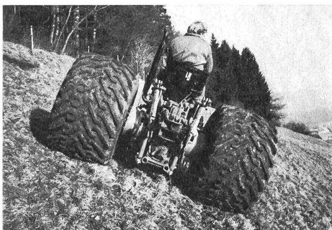
Fig. 1: Ce tracteur, équipé de pneus Terra, roule parallèlement aux courbes de niveau sur un champ d'un taux d'inclinaison d'environ 50%. L'importante largeur de tels pneus rend le montage d'un équipement de sécurité (arceau, cadre, cabine) assez difficile. Mais des études sont actuellement faites en vue d'en réaliser un qui puisse être mis en place sans complications.
