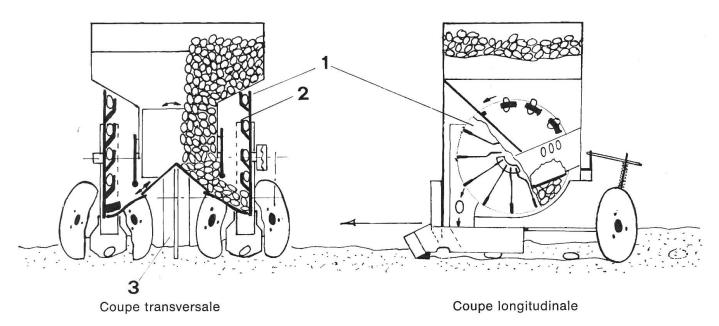
Fig. 8c: Planteuse à alimentation automatique, pour deux lignes, avec disques extracteurs à organes préhenseurs (dessin de fabrique Lerebours)
