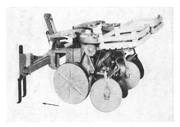
Fig. 7: Planteuse de pommes de terre pour deux lignes à alimentation manuelle. Organe d'alimentation: plateau rotatif horizontal à loges à fond basculant, organe de plantation: conduit de descente (photo de fabrique Müller).
