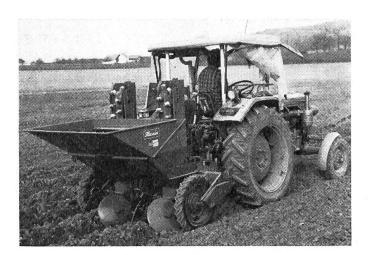
Fig. 2: Planteuse de pommes de terre Hassia GLO 2 à alimentation automatique, avec courroies sans fin à deux rangs de godets, vue à l'œuvre sur le champ.
