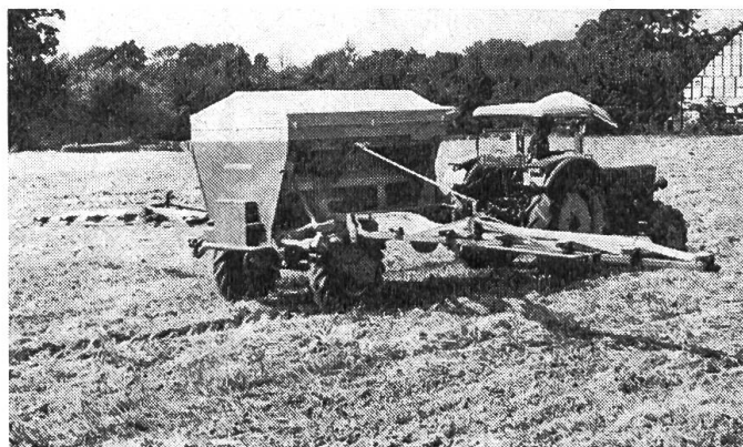
Fig. 1: La barre de distribution de 12 m de cet épandeur de précision pour engrais minéraux, dont les tuyères peuvent être facilement modifiées pour effectuer une fumure normale ou complémentaire, s'efface devant les obstacles éventuels et se replie sans peine.
