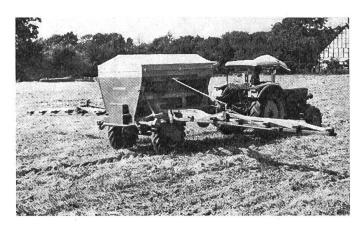
Fig. 1: La barre de distribution de 12 m de cet épandeur de précision pour engrais minéraux, dont les tuyères peuvent être facilement modifiées pour effectuer une fumure normale ou complémentaire, s'efface devant les obstacles éventuels et se replie sans peine
