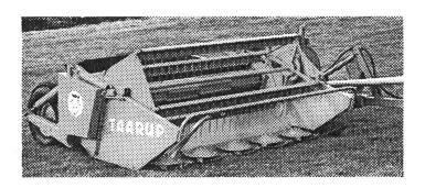
COUPE de 2,10 m. dont la hauteur est contrôlée hydrauliquement. Le RABATTEUR relève le fourrage, dégage la coupe, régularise l'alimentation du CONDITIONNEUR à 2 rouleaux acier avec barettes en quinconce, caoutchoutées, interchangeables.
