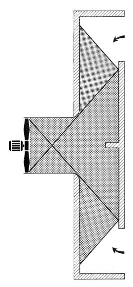
Fig. 10: Amortissement du son avec canal d'aspiration des deux côtés pour ventilateur axial (hélicoïdal).
