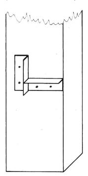
Fig. 3: Cornières en équerre servant de support aux poutres transversales.
