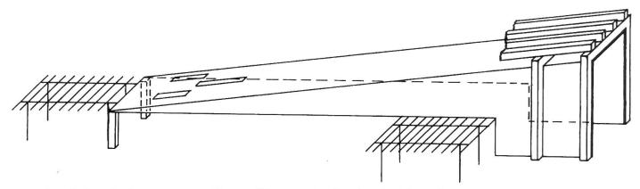
Fig. 5: Canal de refoulement raccordé aux éléments du plancher à claire-voie.
