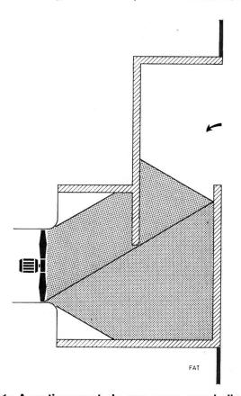
Fag. 13: Amortissement du son avec canal d'aspiration au-dessus du ventilateur.
