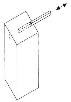
Fig. 7: Bouchon mobile avec latte (à introduire dans les trous) qui facilite son relevage.
