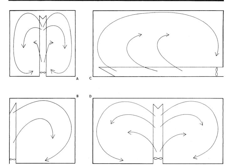
Fig. 4: :Disposition du ventilateur et du canal de refoulement selon la forme du tas de foin.
