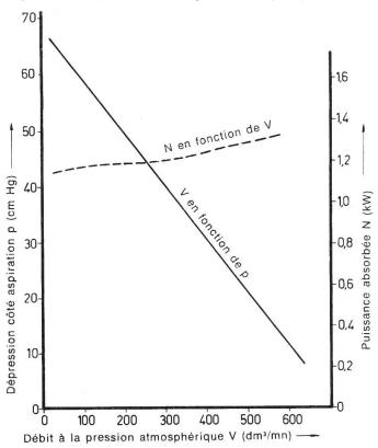
cette dernière aspire encore le même volume d'air, mais cet air est moins dense. Si l'on convertit en litres d'air libre, on voit donc que la capacité de travail de la pompe diminue devant elle. Cette relation est représentée sur la Figure 1, laquelle a été extraite d'un rapport d'essai de la DLG (Société allemande d'agriculture) concernant une pompe à vide.
