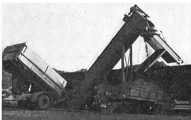
Fig. 1: Vidage de la remorque du tracteur avec le fond mouvant à traverses dans la trémie collectrice encastrée. A droite, l'élimination des corps étrangers par la grille à barreaux et le chargement des betteraves sucrières dans le wagon sont bien visibles. On peut également voir l'évacuation des corps étrangers (terre, pierres, feuilles) par le toboggan et leur chute dans la remorque qui se trouve au-dessous.
