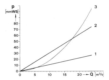
Fig. 2: Courbes caractéristiques de l'installation de ventilation
