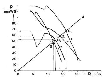
Fig. 4: Choix d'un ventilateur sur la base des courbes caractéristiques de l'installation de ventilation et du ventilateur
