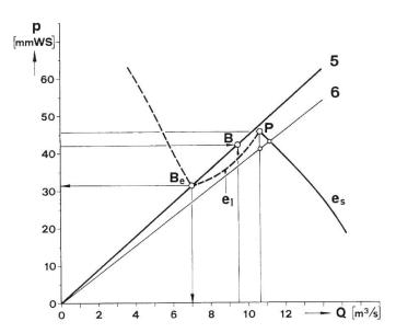
Fig. 5: Appréciation d'un ventilateur avec zone de fonctionnement instable
