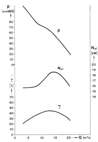
Fig. 1: Courbes caractéristiques du ventilateur p Pression en mm CE (à la colonne d'eau)
