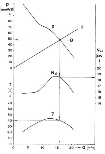
Fig. 3: Détermination d'un point de fonctionnement
