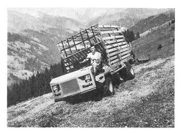
Fig. 4: Autochargeuse autotractée «Cargotrac CC 15-S» avec dispositif ramasseur-chargeur monté entre les essieux. Puissance du moteur: 40 ch. Fabricant: Rapid SA, fabrique de machines et véhicules, 8953 Dietikon ZH.
