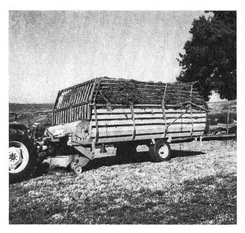
Fig. 1: Remorque autochargeuse à 2 roues (semiportée) «Agrar LW-30», à grande capacité de réception, pourvue d'une superstructure repliable. Contenance: 30 m³ pour les fourrages secs et 17 m³ pour les fourrages verts. Dispositif ramasseur-chargeur à l'avant.
