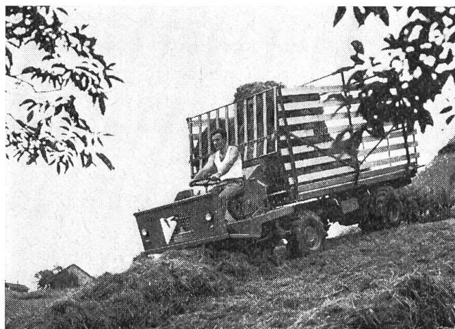
Fig. 5: Autochargeuse autotractée «LT2» avec dispositif ramasseur-chargeur placé à l'avant. Puissance du moteur: 40 ch. Capacité de réception: 8 m 3 pour les fourrages verts et 14 m 3 pour les fourrages secs. Fabricant: Schilter SA, fabrique de machines, 6370 Stans NW.
