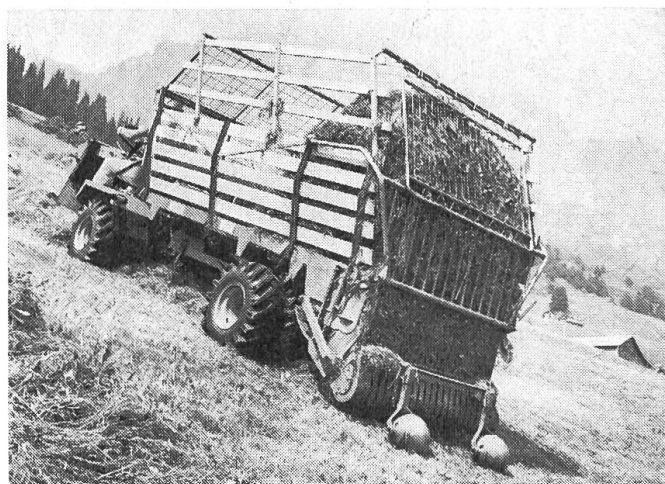
Fig. 3: Autochargeuse autotractée avec dispositif ramasseur-chargeur disposé à l'arrière et superstructure repliable. Capacité de réception: 11 m 3 , puissance du moteur: de 30 ch à 40 ch. Fabricant: Rapid SA, fabrique de machines et véhicules, 8953 Dietikon ZH.
