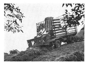
Fig. 5: Autochargeuse autotractée «LT2» avec dispositif ramasseur-chargeur placé à l'avant. Puissance du moteur: 40 ch. Capacité de réception: 8 m³ pour les fourrages verts et 14 m³ pour les fourrages secs. Fabricant: Schilter SA, fabrique de machines, 6370 Stans NW.
