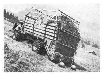
Fig. 3: Autochargeuse autotractée avec dispositif ramasseur-chargeur disposé à l'arrière et superstructure repliable. Capacité de réception: 11 m³, puissance du moteur: de 30 ch à 40 ch.
