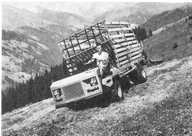
Fig. 4: Autochargeuse autotractée «Cargotrac CC 15-S» avec dispositif ramasseur-chargeur monté entre les essieux. Puissance du moteur: 40 ch. Fabricant: Rapid SA, fabrique de machines et véhicules, 8953 Dietikon ZH.
