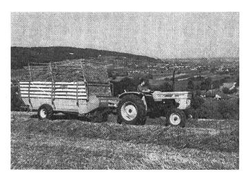
Fig. 2: Remorque autochargeuse à 2 roues (semiportée) du modèle «T 20», à plateau de charge surbaissé, munie d'une superstructure repliable. Capacité de réception: 19 m³ pour les fourrages secs et 11 m³ pour les fourrages verts. Dispositif ramasseurchargeur à l'avant.
