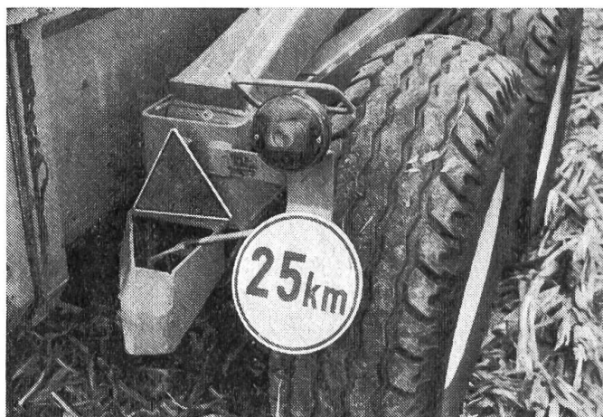
Fig.2 et 3: Solutions de conception simple imaginées pour protéger les glaces diffusantes des feux clignotants. Lors de l'achat d'une installation de clignoteurs, il convient d'attacher de l'importance à ces soi-disant détails. On évitera ainsi bien des ennuis inutiles.
