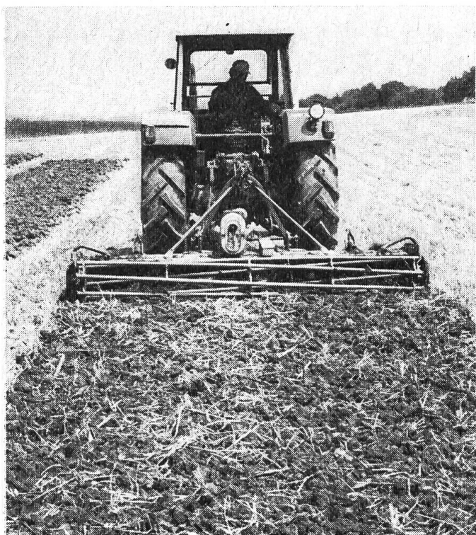
Fig. 9: Le déchaumage de ce champ, où l'on avait également cultivé une céréale, a été effectué par une herse à toupies lors de conditions de travail favorables.
