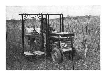
Fig. 1: Epandage d'herbicides de printemps avec sarcleuse chimique portée sur tracteur vigneron interligne. La potence à fixation ventrale permet d'enjamber le rang.
