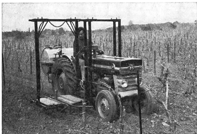
Fig. 1: Epandage d'herbicides de printemps avec sarceuse chimique portée sur tracteur vigneron interligne. La potence à fixation ventrale permet d'enjamber le rang.
