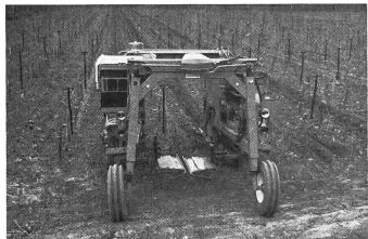
Fig. 2: Sarcleuse chimique adaptée sur tracteur enjambeur.
