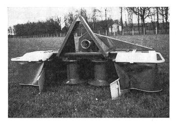
pour le montage frontal. Comme toutes les faucheuses rotatives PZ, ses pignons coniques se trouvent dans un bain de graisse. 4 tambours forment 2 andains aérés. La GF 215 est livrable pour prise de force tournant à gauche ou à droite avec 540 ou 1000 tr/min, et elle est équipée de l'attelage rapide Weiste-ACCORD.
