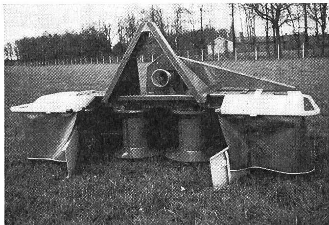
pour le montage frontal. Comme toutes les faucheuses rotatives PZ, ses pignons coniques se trouvent dans un bain de graisse. 4 tambours forment 2 andains aérés. La GF 215 est livrable pour prise de force tournant à gauche ou à droite avec 540 ou 1000 tr/min, et elle est équipée de l'attelage rapide Weiste-ACCORD.
