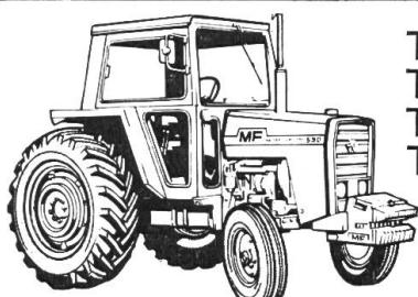
Tracteur MF-560 Supercab 56 CV DIN à 2000 t/min.
