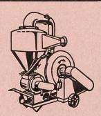
Transporteurs à grains mécaniques ou pneumatiques
