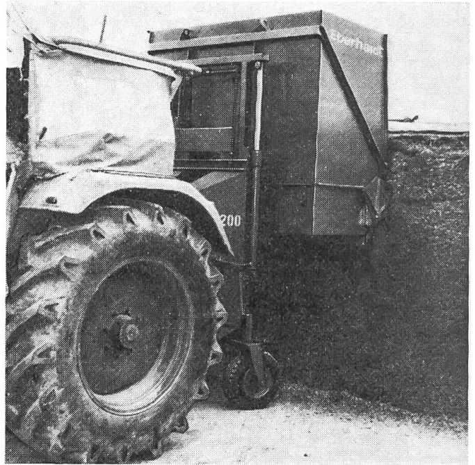
La même machine en train d'extraire du fourrage d'un silo-couloir. (A noter le travail impeccable qu'elle exécute).
