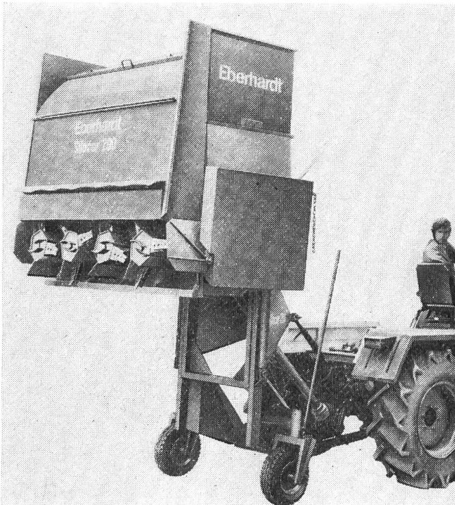
Désileuse avec fraises à 3 couteaux, se relevant et s'abaissant à la verticale, accouplée à l'arrière d'un tracteur.
