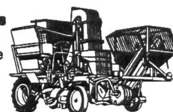
Décolleteuses- arracheuses-chargeuses pour betteraves, trainées ou automotrice
