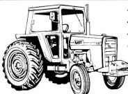
Tracteur MF-560 Supercab 56 CV DIN à 2000 t/min. Tracteur MF-575 Supercab 66 CV DIN à 2000 t/min. Tracteur MF-590 Supercab 75 CV DIN à 2200 t/min. Tracteur MF-595 Supercab 88 CV DIN à 2000 t/min.
