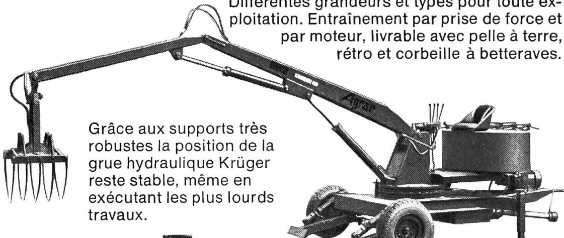
Grâce aux supports très robustes la position de la grue hydraulique Krüger reste stable, même en exécutant les plus lourds travaux.
