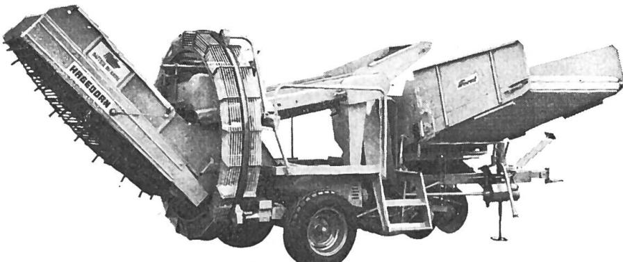
Sur les terrains inclinés le réglage hydraulique de l'essieu et la voie réglable jusqu'à 2,4 m offrent des grandes avantages!
