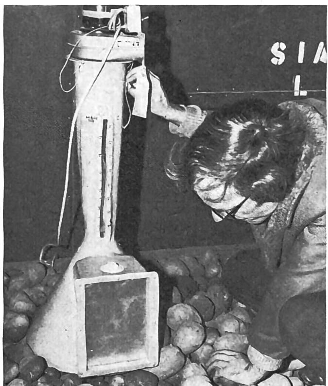
surface des produits de récolte dès le moment où la vitesse de l'air de ventilation s'avère inférieure à celles du champ de mesure de la plupart des anémomètres. Il peut mesurer des flux d'air dont la vitesse varie de 0 à 0,2 mètre-seconde (m/s).
