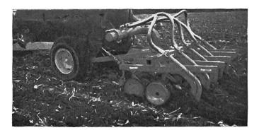
Fig. 2: Cette combinaison de matériels, qui comporte une fraiseuse à lames et des tuyaux distributeurs, permet d'enfouir de grandes quantités de lisier dans le sol en le répartissant régulièrement. Le lisier est transporté dans un réservoir qui est monté soit sur le tracteur soit sur un véhicule roulant en parallèle. Une pompe l'extrait du réservoir et le dirige vers les tuyaux distributeurs.
