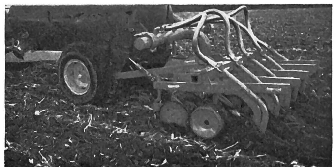
Fig. 2: Cette combinaison de matériels, qui comporte une fraiseuse à lames et des tuyaux distributeurs, permet d'enfouir de grandes quantités de lisier dans le sol en le répartissant régulièrement. Le lisier est transporté dans un réservoir qui est monté soit sur le tracteur soit sur un véhicule roulant en parallèle. Une pompe l'extraît du réservoir et le dirige vers les tuyaux distributeurs.
