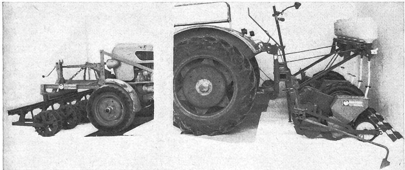
Tracteur de type courant équipé d'une batterie de petits rouleaux monorâne Cambridge à l'avant et d'une batterie correspondante de semoirs monograine à l'arrière (accouplée au système d'attelage trois-points). Cette combinaison de matériels de travail, imaginée et réalisée par la firme Rau, permet d'obtenir une levée plus régulière des semences de betteraves sucrières, et, par conséquent, un rendement plus important de la culture.
