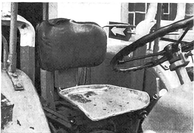
Fig. 4: Usure excessive d'un siège de série pour conducteur de tracteur (le rembourrage est complètement détérioré). (Photo FAT)
