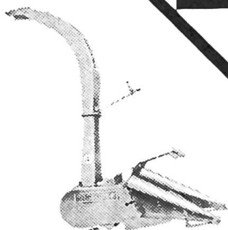
Ensileuse de maïs Hagedorn, tambour rotatif à grande vitesse avec 9 cou- teaux, longueur de coupe 4,5 à 6 mm, capacité de 25 à 30 t/h, vitesse de travail 5 à 8 km/h puissance requise 30 à 60 CV
