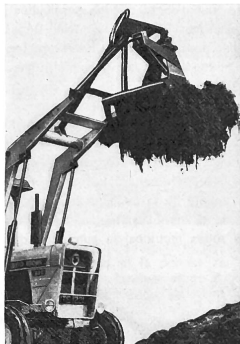
Fig. 6: De nouveaux équipements, tels que cette griffe à ouverture et fermeture commandées, augmentent encore la grande polyvalence du chargeur hydraulique frontal porté.
