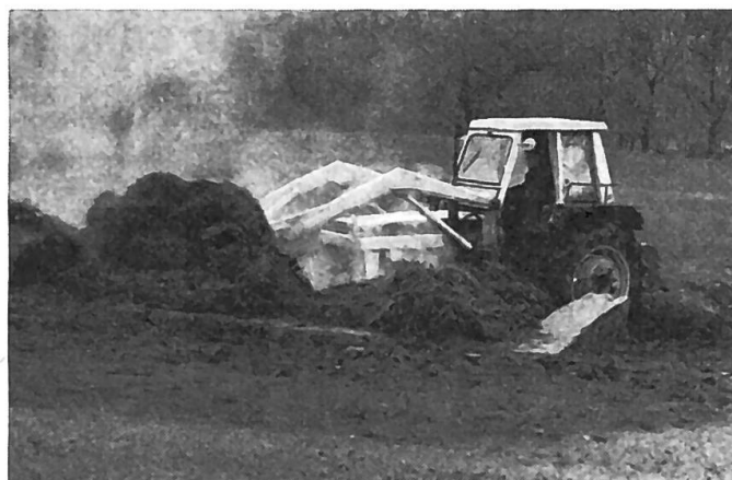
Fig. 2: Tracteur muni d'un chargeur hydraulique frontal qui permet la pose et la dépose rapides des équipements de travail. Le démontage du chargeur se fait de la manière indiquée sur la Figure 3.
