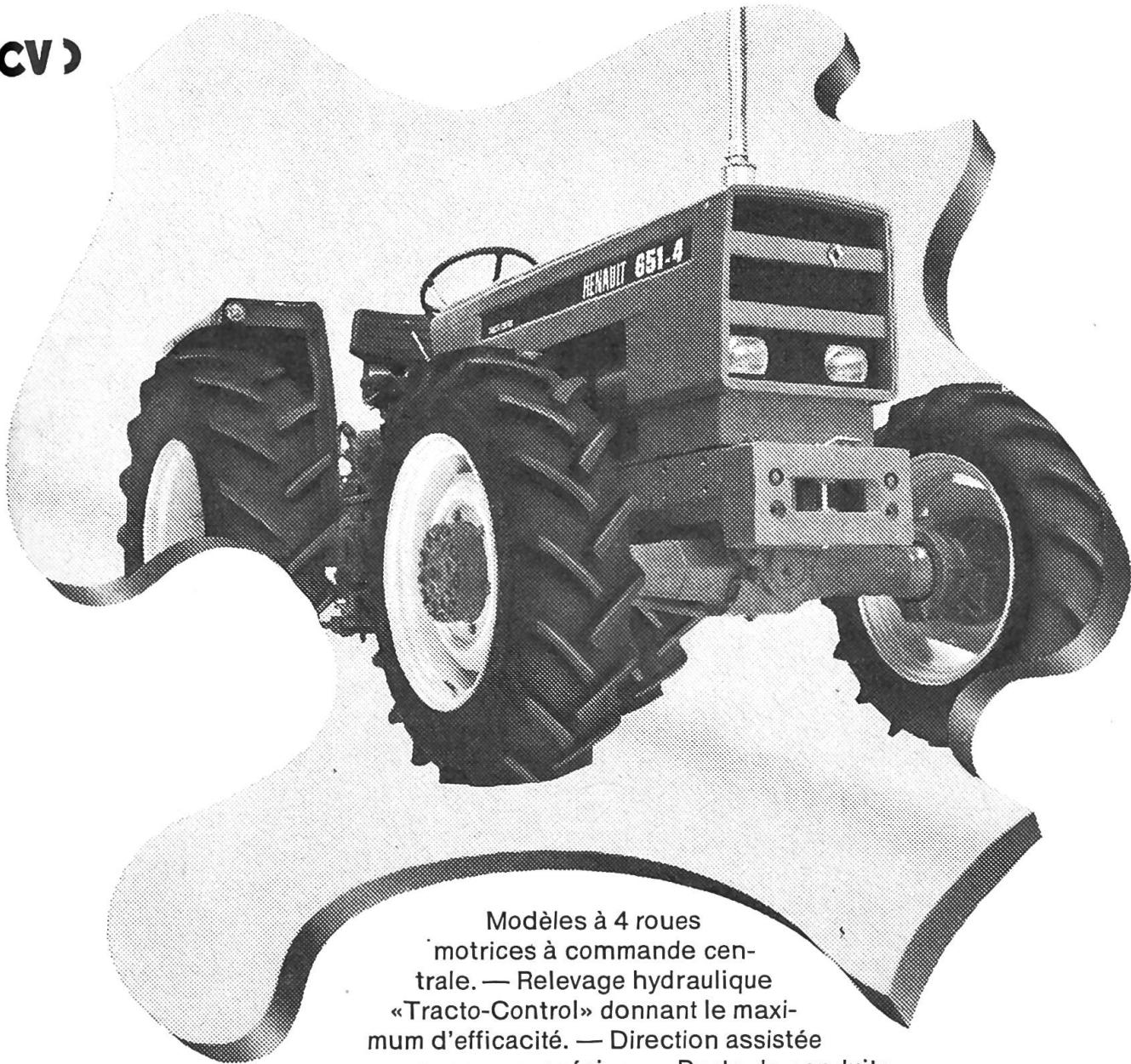
Modèles à 4 roues motrices à commande centrale. — Relevage hydraulique «Tracto-Control» donnant le maximum d'efficacité. — Direction assistée pour une manœuvre précise. — Poste de conduite moderne avec siège «Super-Confort» à suspension réglable.
