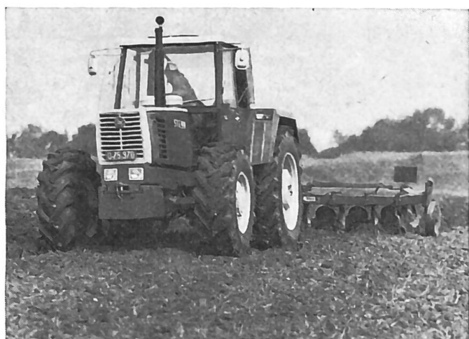
Fig. 1: Les nouveaux tracteurs Steyr 1200a et 1400a peuvent être également livrés avec un équipement spécial pour les travaux forestiers. La consommation spécifique de carburant de leurs moteurs à injection directe n'étant que de 157 g/ch/h, elle rend ces derniers très économiques.
