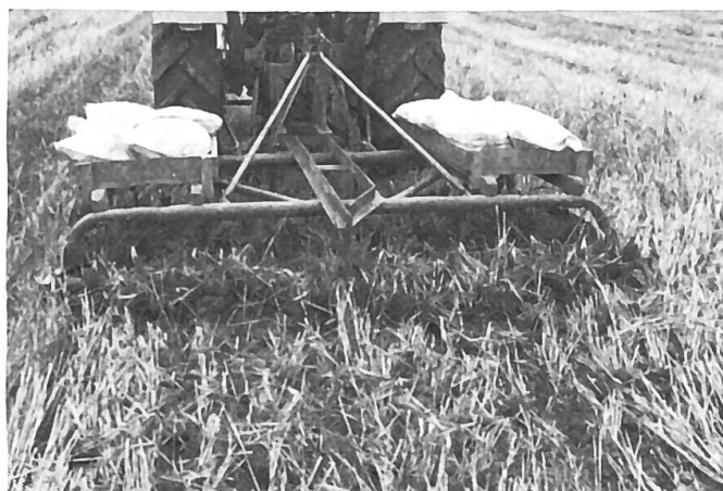
Fig. 6: Il est possible d'éviter les bourrages si la paille ou les longues éteules ont été hachées court au préalable et que le déchaumage est effectué par temps sec.
