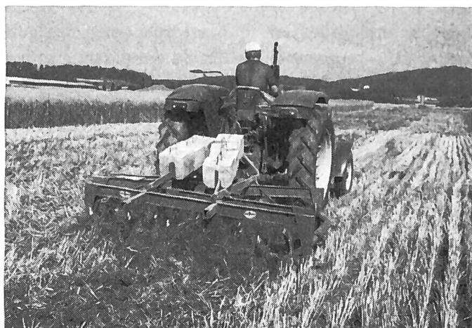
Fig. 5: Lors des travaux de déchaumage, il est indiqué d'alourdir fortement la herse roulante à lames. En outre, le deuxième passage de l'instrument devrait être autant que possible croisé (à angle droit ou en diagonale).
