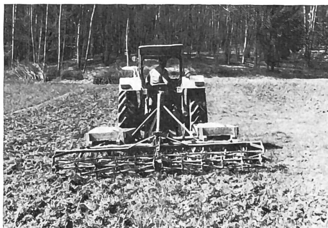
Fig. 7: L'utilisation des herse roulantes à lames pour le scarifiage de la couche herbeuse des prairies s'avère faisable mais exige une grande dépense de travail.
