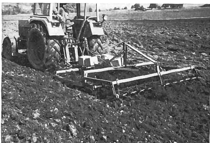
Fig. 8: L'accouplement d'une émotteuse à l'arrière de la herse roulante à lames permet d'obtenir une importante amélioration de la qualité des lits de germination.
