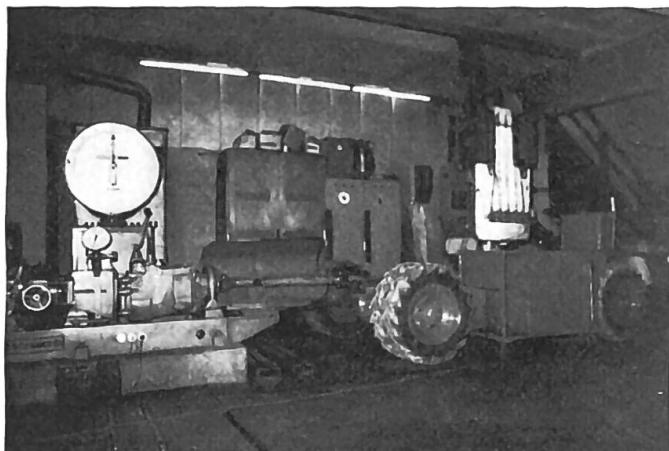
Détermination, au banc d'essai, de la puissance fournie à la prise de force. Entre les deux essieux se trouve le dispositif prévu pour mesurer la consommation de carburant.
