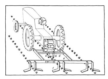
Fig. 6: Sarcleuse portée avec système de guidage automatique des outils
