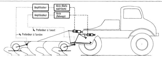
Fig. 7: Réglage électro-hydraulique (à deux circuits) de la profondeur de travail d'une charrue portée polysoc
