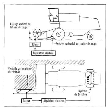
Fig. 4: Système de direction automatique pour moissonneuse-batteuse
