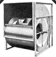
Séchage du foin par ventilation silencleuse Neuero, galvanisée, possibilité de chauffage (à mazout, gaz ou électricité).
