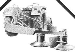
Faucheuse à coupe rapide Müller, de grande sécurité, solidité et productivité. Largeurs de travail 135 et 165 cm (dispositif de sécurité démonté). Le prix? Agréablement étonnnant!
