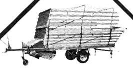
Autochargeuse Hagedorn, système Weichel, 6 modèles, contenance de 8 à 30 m³, exécution normale et surbaissée. Dispositifs de coupe avec 3, 7 ou 13 couteaux. Une des premières.... Une des meilleures!
